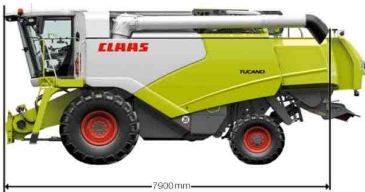
Rys. 2. Schemat kombajnu Claas Tucano 420 - wymiary podane w [mm]
