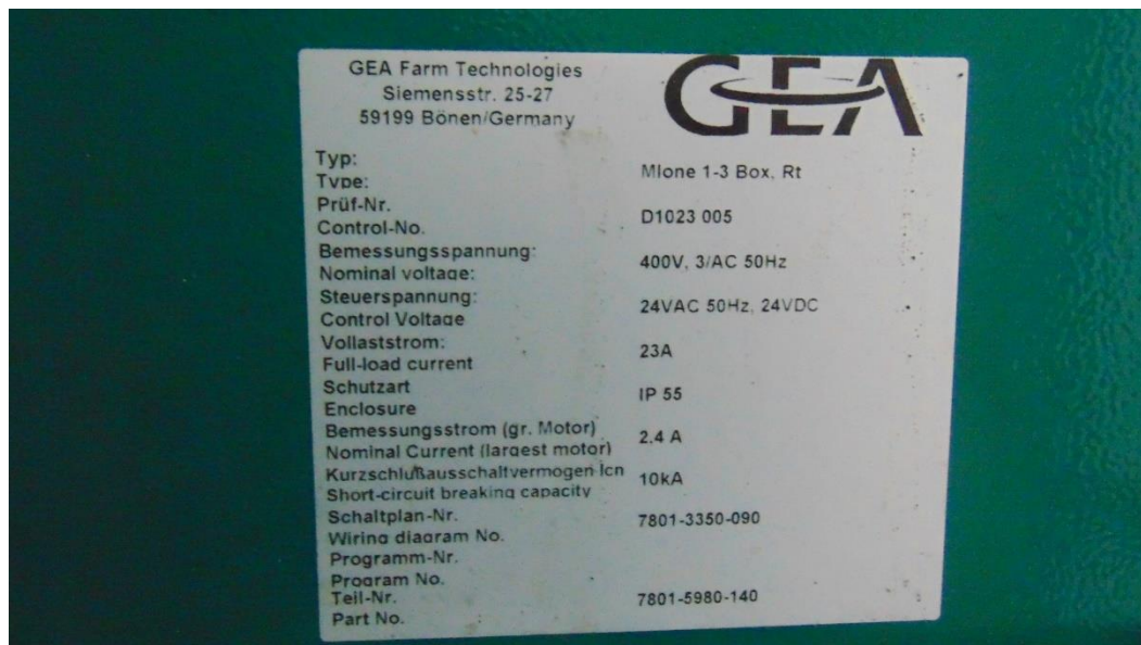
34. Tabliczka znamionowa robota udojowego.
