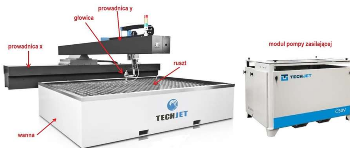
Rys. nr 1. Schemat poglądowy urządzeń wycinarki wodnej Techjet PowerJet 1530
